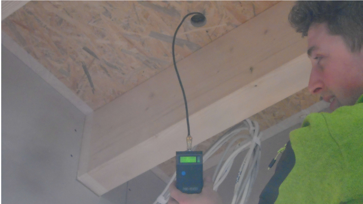
Mit dem Feuchte-Sensor wurden eine Feuchte von 100 % in der Dämmung gemessen. Bild 23.2.2021
